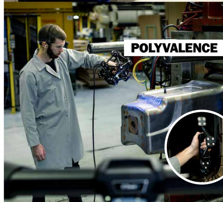
Le MetraSCAN 3D possède 15 croix laser et une cadence de mesure élevée permettant d'accélérer le temps de numérisation. De la configuration rapide aux numérisations en temps réel, jusqu'aux fichiers prêts à utiliser, le processus de mesure n'a jamais été aussi rapide. Le gain de temps obtenu pour la mesure, l'acquisition et l'analyse des données est tout simplement impressionnant !
