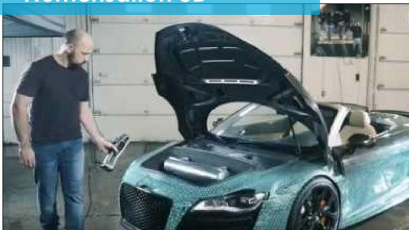
**Numérisation** d'une voiture à l'aide d'un scanner 3D Creaform **Go Scan Spark**.
