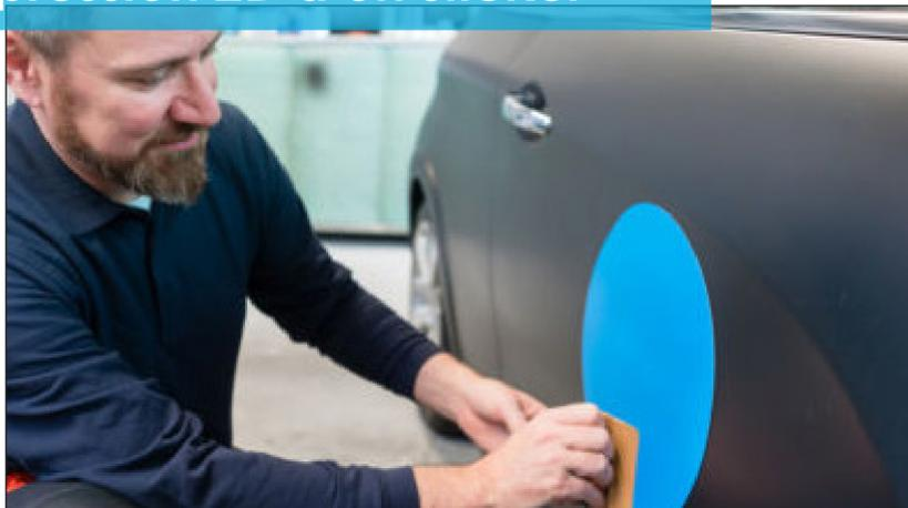
Le **patron** est imprimé sous la forme de stickers autocollants (covering).
