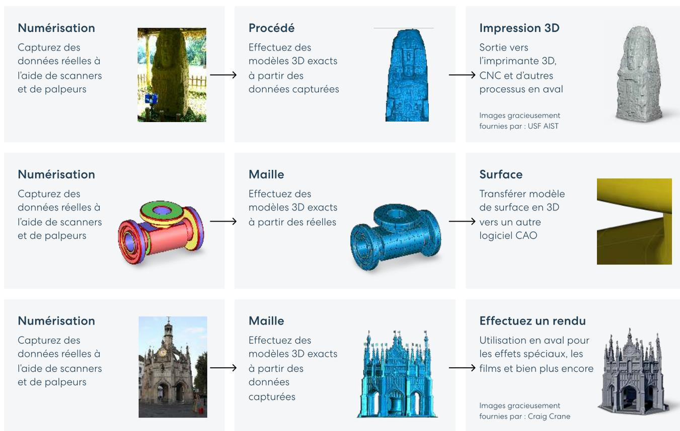
**Geomagic Wrap prend en charge tous les numériseurs 3D, les caméras et les scanners au format XYZ/ASCII et gère des données de volume et de surface ordonnées ou non ordonnées.**
